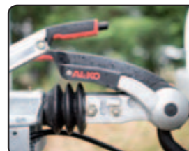
Stabilisateur anti-lacets ALKO Safety coupling
