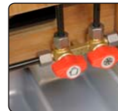
Répartiteur central de gaz Central gas distributor
